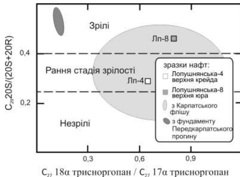
Рис. 9.4.1. Діаграма стеран C_{29}20S/(20S+20R) – Ts/Tm (Radkovets et al., 2016). Поля зрілості (за Peters and Moldovan, 1993)
