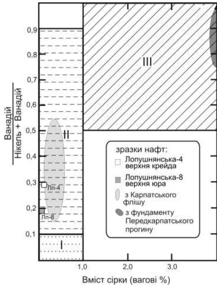
Рис. 9.3.6. Діаграма відношення V/(V+Ni) – вміст сірки в нафтах (Radkovets et al., 2016). Класифікація умов седиментації вихідного керогену (за Lewan, 1984)
